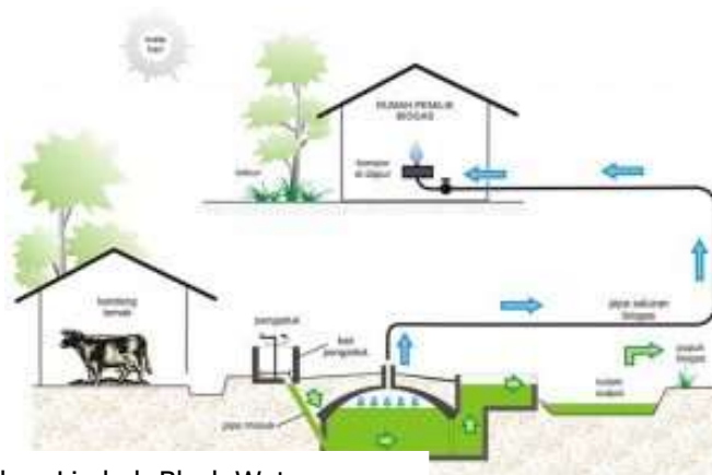
Gambar 4.7 Pengolahan Limbah Black Water Komunal
